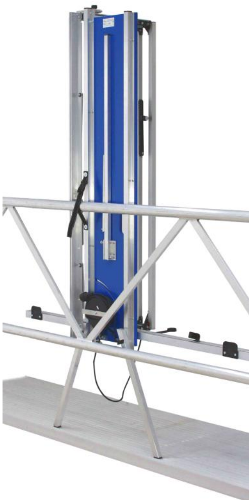
Abb.: Mit Gurt kippstabil am Geländer gesichert Illustration : Fixé au garde-corps par une sangle pour éviter tout basculement
